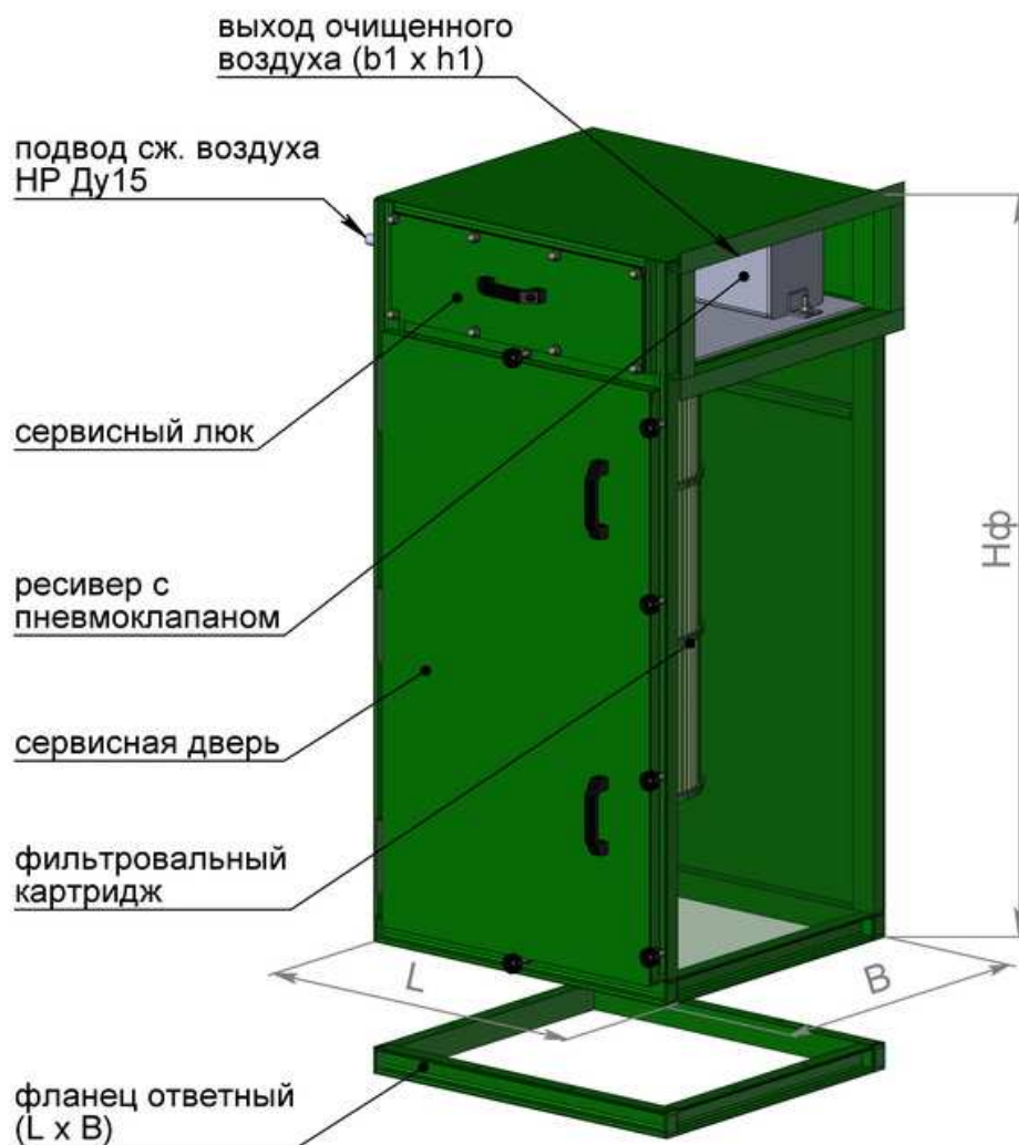
СРФ1КС Фильтр картриджный с импульсной продувкой в силосном исполнении
